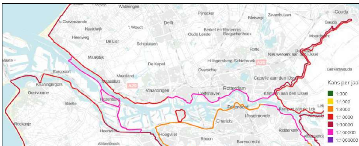
Figuur 3-1 Normspecificaties voor primaire waterkeringen, uitgedrukt in een overstromingskans per dijktraject [1]
