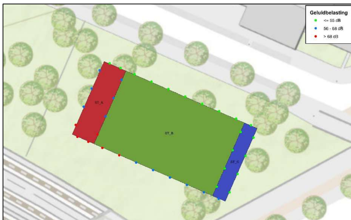
Figuur 4.4: Bouwvlakken Stroveer - Maximale geluidbelasting per ontvanger
