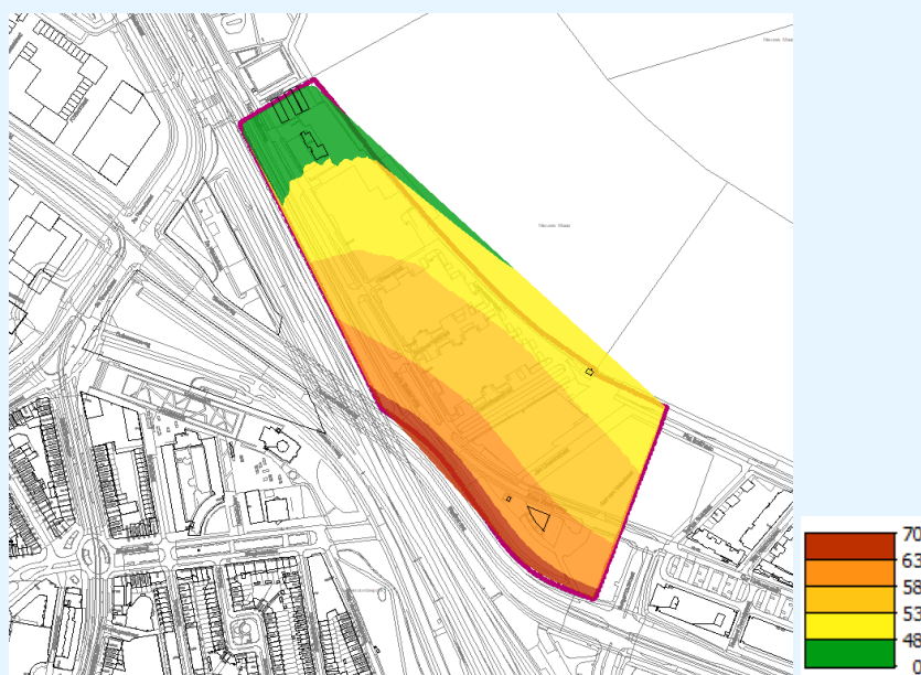
figuur 3: geluidscontouren Laan van Zuid/Varkenoordseviaduct (inclusief trams, na aftrek 5 dB)
