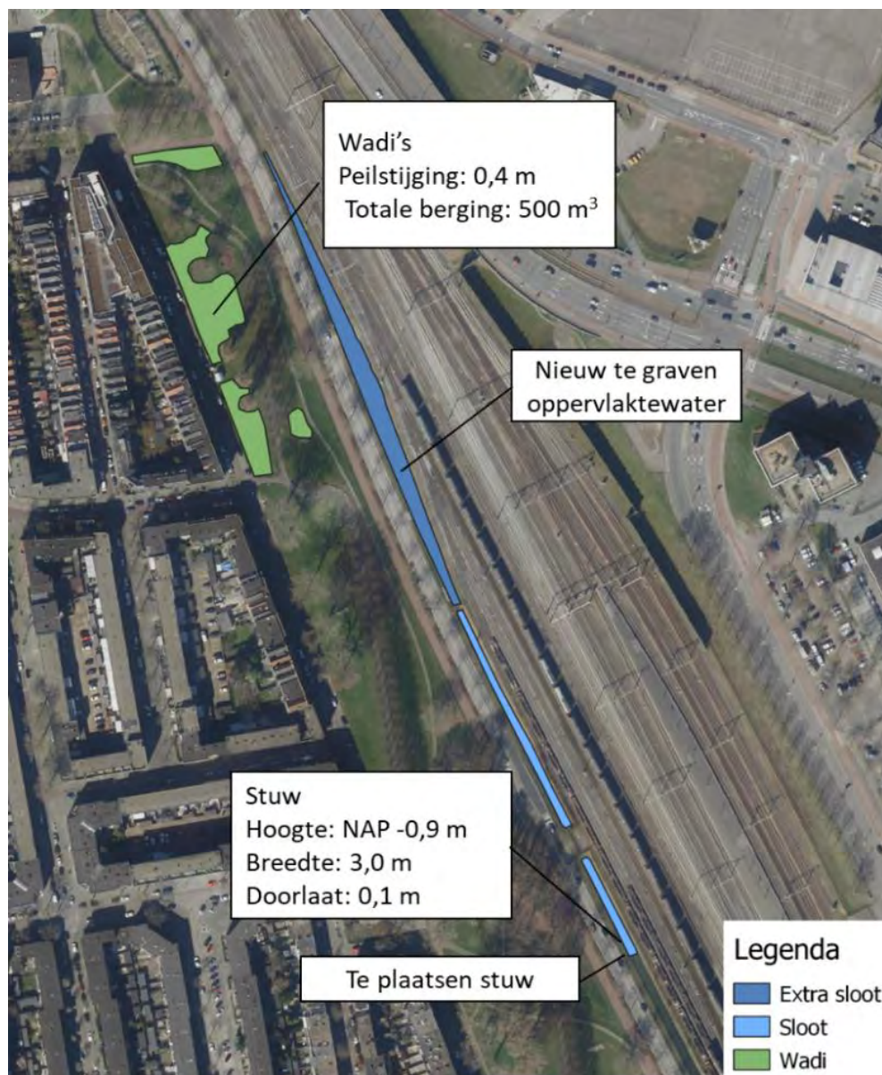
Figuur 13 Wadi's aanleggen, oppervlaktewater graven en stuw verplaatsen
