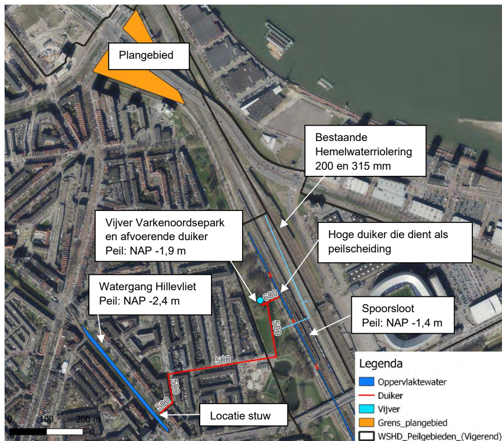
Figuur 2 Oppervlaktewatersysteem in en rond het plangebied
