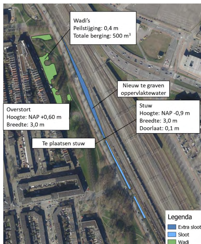
Figuur 10 Wadi's aanleggen, plaatsten stuw en graven oppervlaktewater
