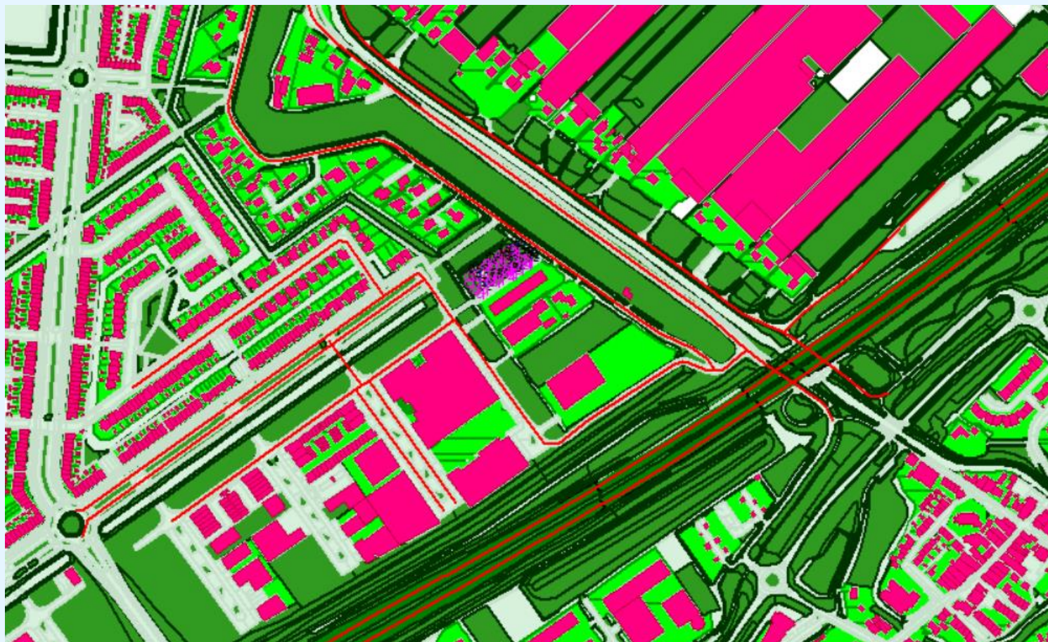
figuur B2.1: 2D weergave rekenmodel inclusief ligging wegen, gebouwen, bodemgebieden en rekenpunten
