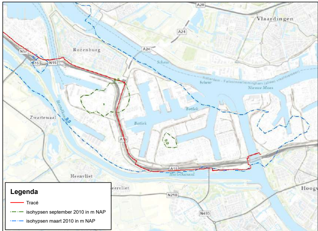
Figuur 2.5: Isohypsens TNO/grondwatertools eerste watervoerende pakket maart 2010 respectievelijk september 2010
