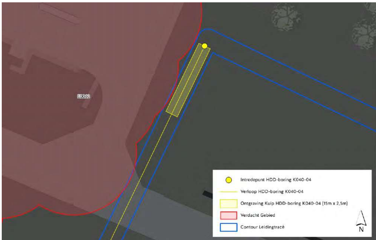
Figuur 21 Locatie en afmeting van de ontgraving voor de kuip van HDD-boring K040-04 ten opzichte van het contour van het leidingtracé en verdacht gebied E0013.
