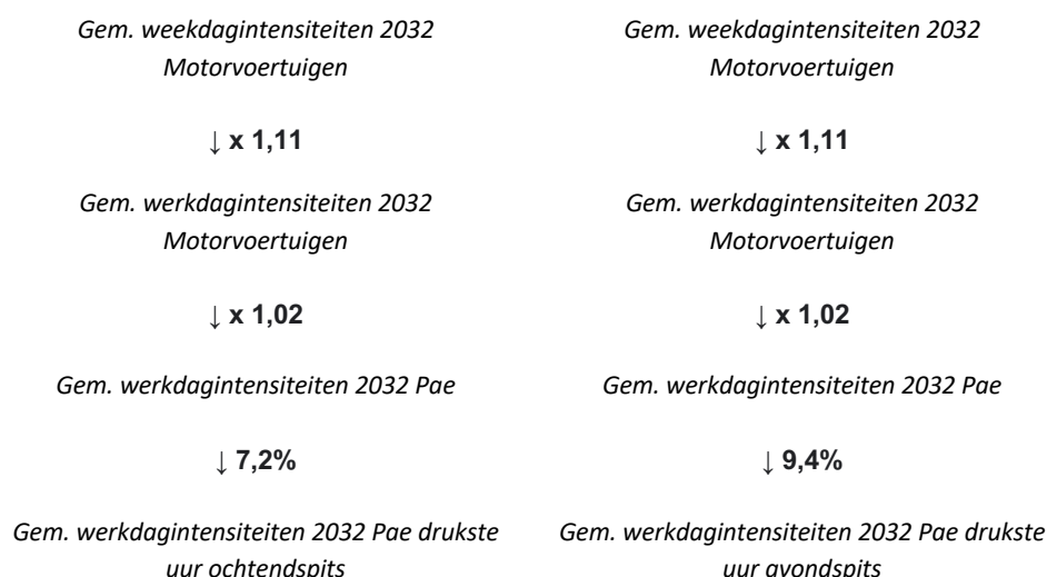
Figuur 2. Uitgevoerde berekeningen met intensiteiten
