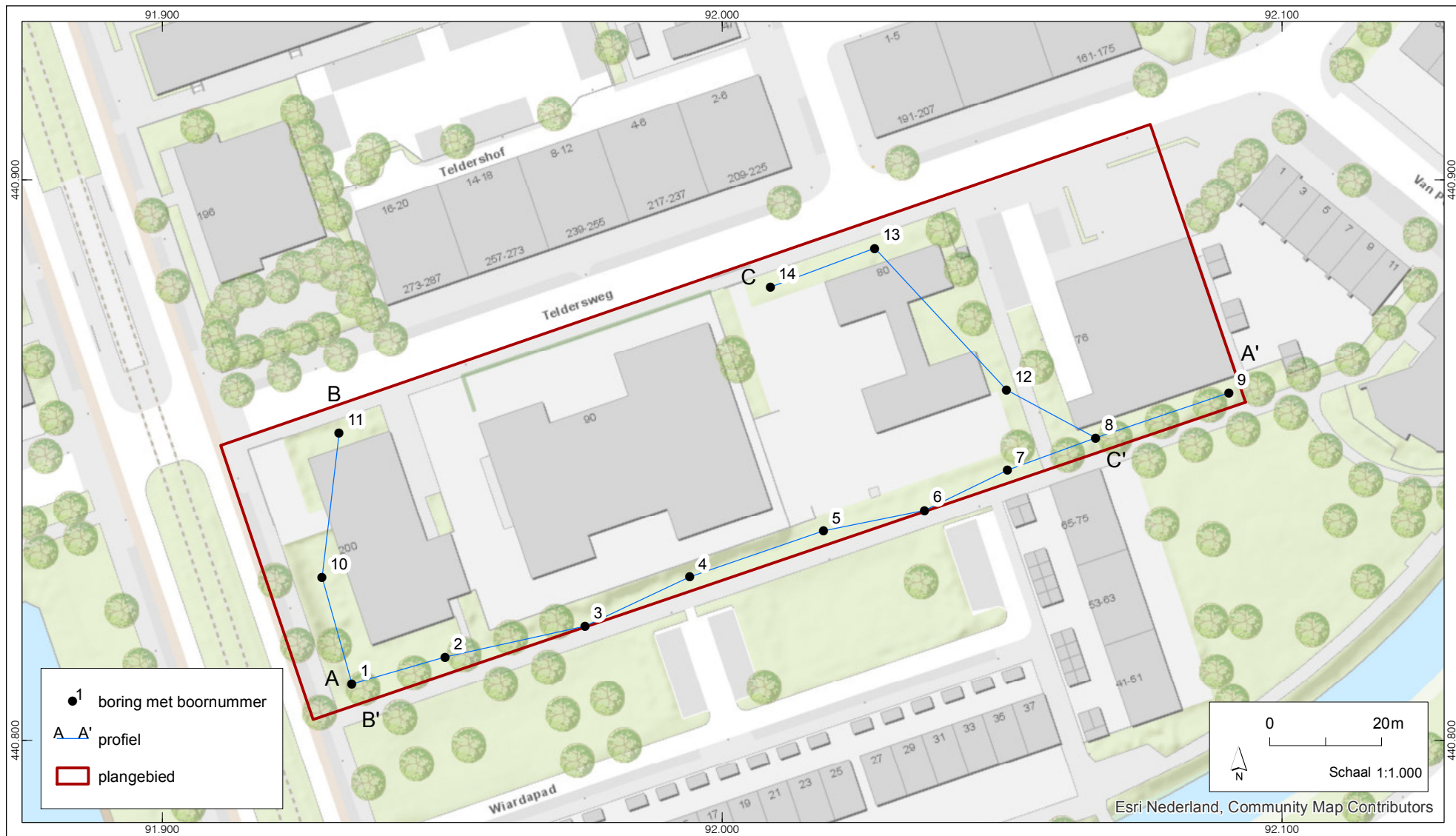
Afb. 5. Ligging boorpunten en profielen A-A', B-B' en C-C'.
