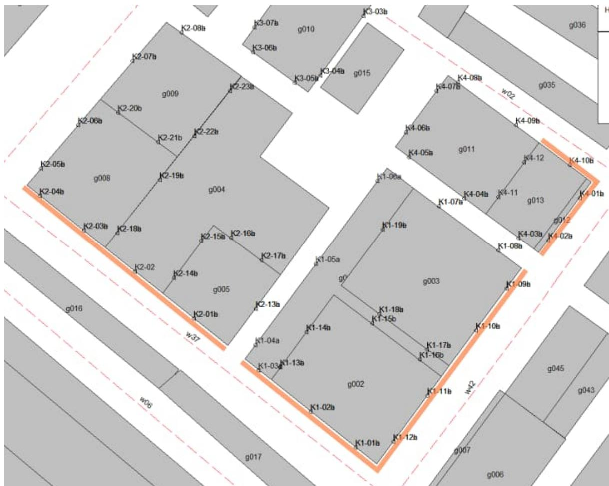
figuur 4.1.: gevels met een eis voor de geluidwering in het kader van een goede ruimtelijke ordening (oranje gemarkeerd)
