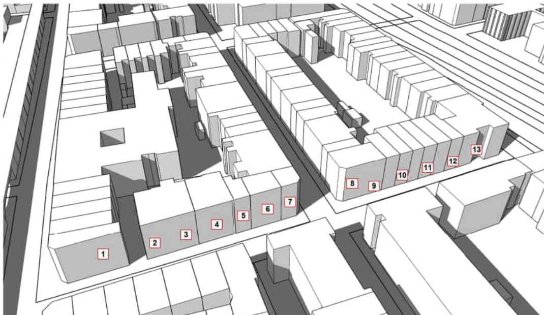
figuur 3.5: positie toetspunten op gevel Herlaerstraat
