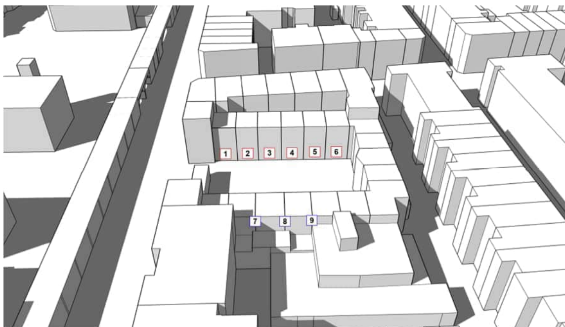
figuur 3.13: positie toetspunten op gevel Vijverhofstraat (Hofje)
