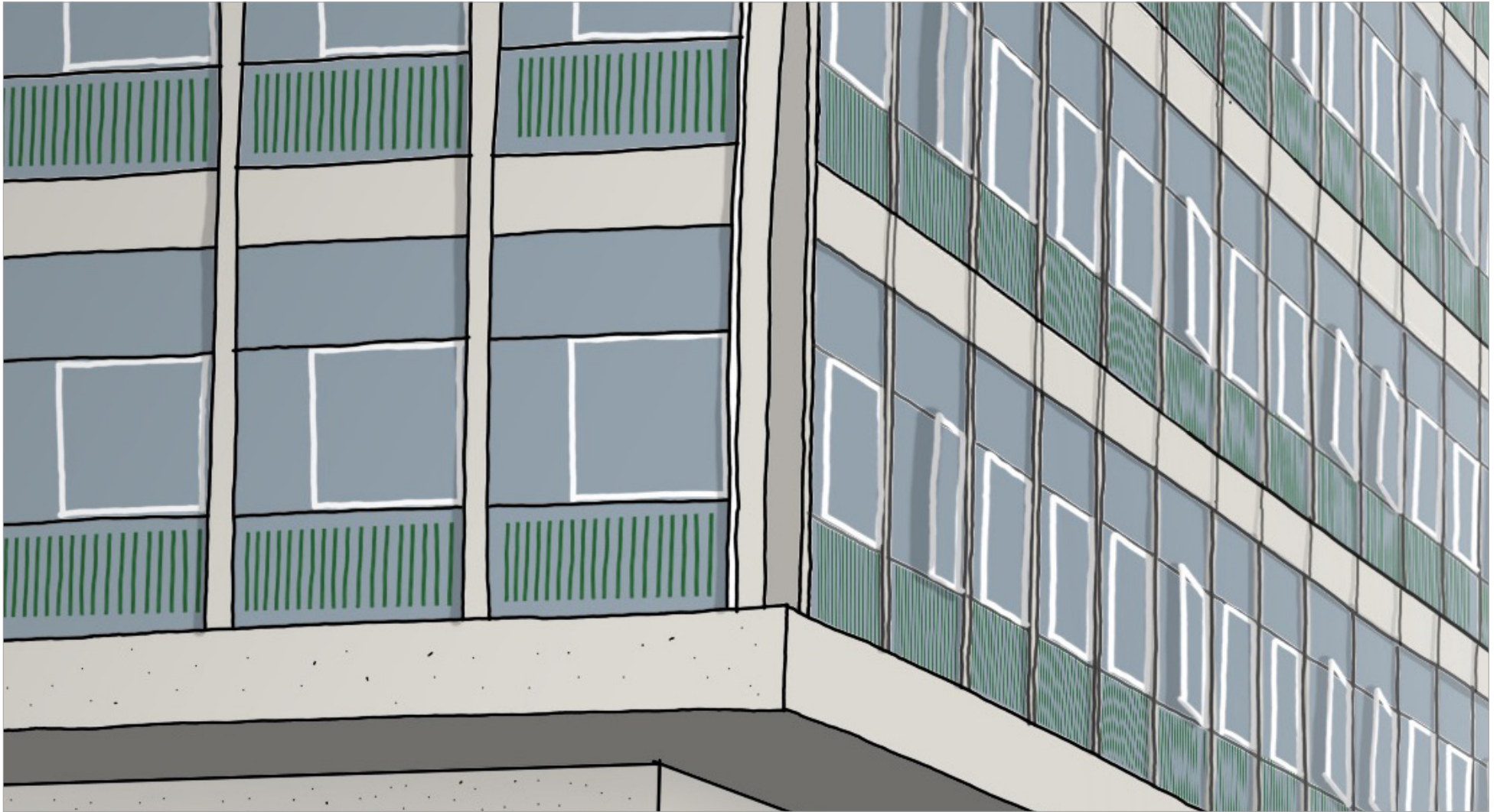
Getekende reconstructie van de oorspronkelijke weefselgevel. Deze tekening is gebaseerd op een historische foto van kort na de oplevering. Voor de toelichting zie de tekst op de vorige pagina.
