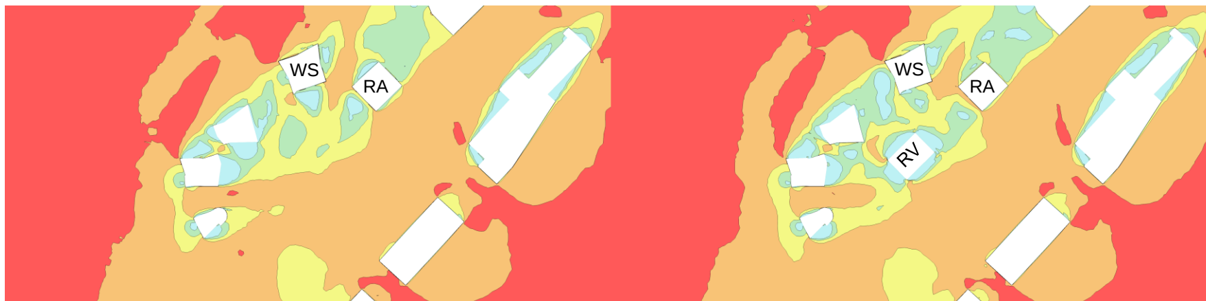
Figuur 5. Overschrijdingskans drempelsnelheid 5 m/s op een hoogte van 40 m. Bestaande situatie (links), toekomstige situatie (rechts)
