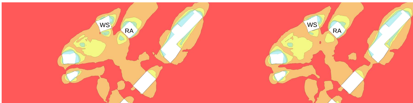
Figuur 8. Overschrijdingskans drempelsnelheid 5 m/s op een hoogte van 70 m. Bestaande situatie (links), toekomstige situatie (rechts)
