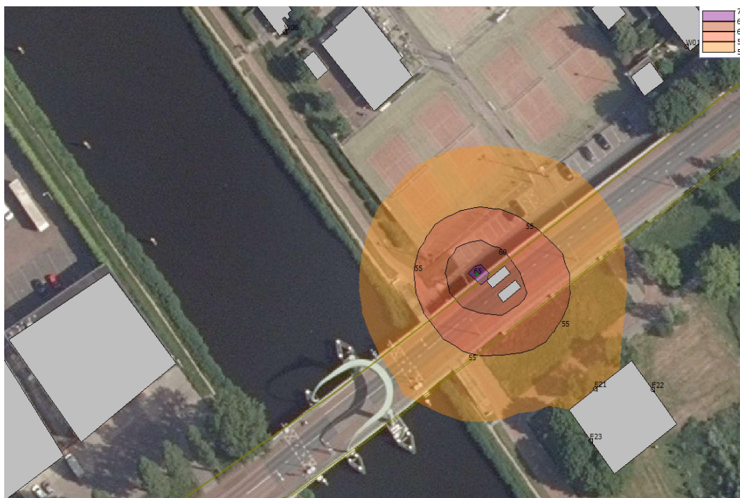
f4 Berekende globale etmaalwaardcontouren in dB(A), ontvangerhoogte 10 m, bedrijf met ketel 2
