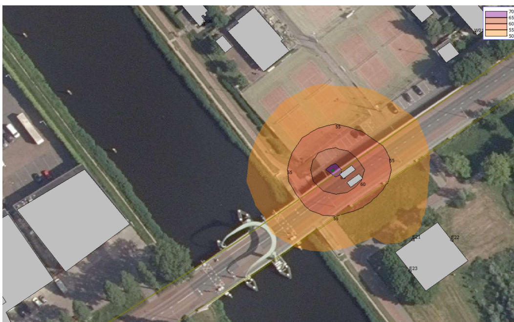
f4 Berekende globale etmaalwaardcontouren in dB(A), ontvangerhoogte 10 m, bedrijf met ketel 2
