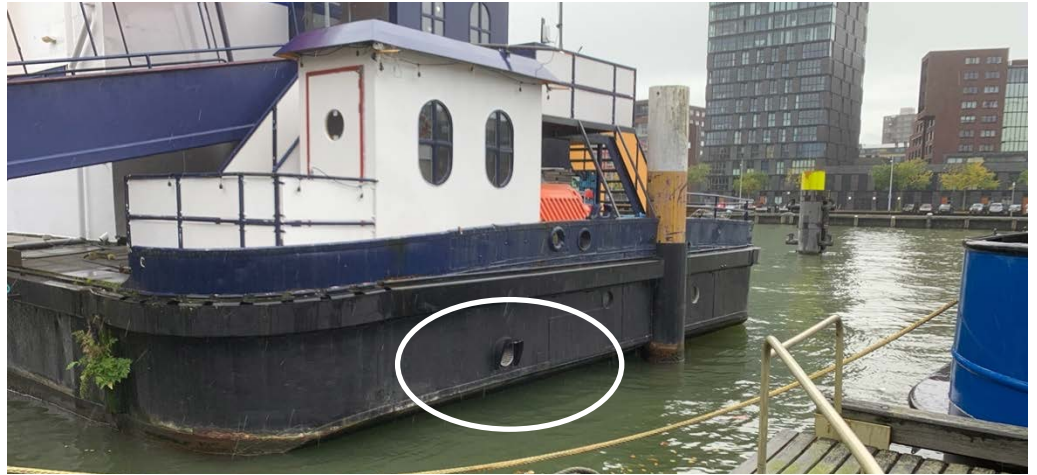
Figuur 13 Lasergame Zwarte Zwaan, luchtafvoer (bron: dBvision)
