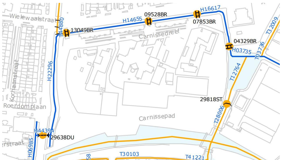
Figuur 3-1 Legger Waterschap Hollandse Delta. De blauwe lijnen zijn hoofdwatervgangen. De oranje lijnen zijn overige watervgangen. DU=Duiker, BR=Brug, ST=Stuw.
