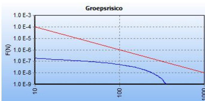
Figuur 6 fN-curve van de maatgevende kilometer
