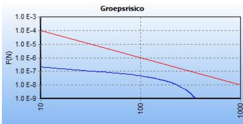
Figuur 9 fN-curve van de maatgevende kilometer
