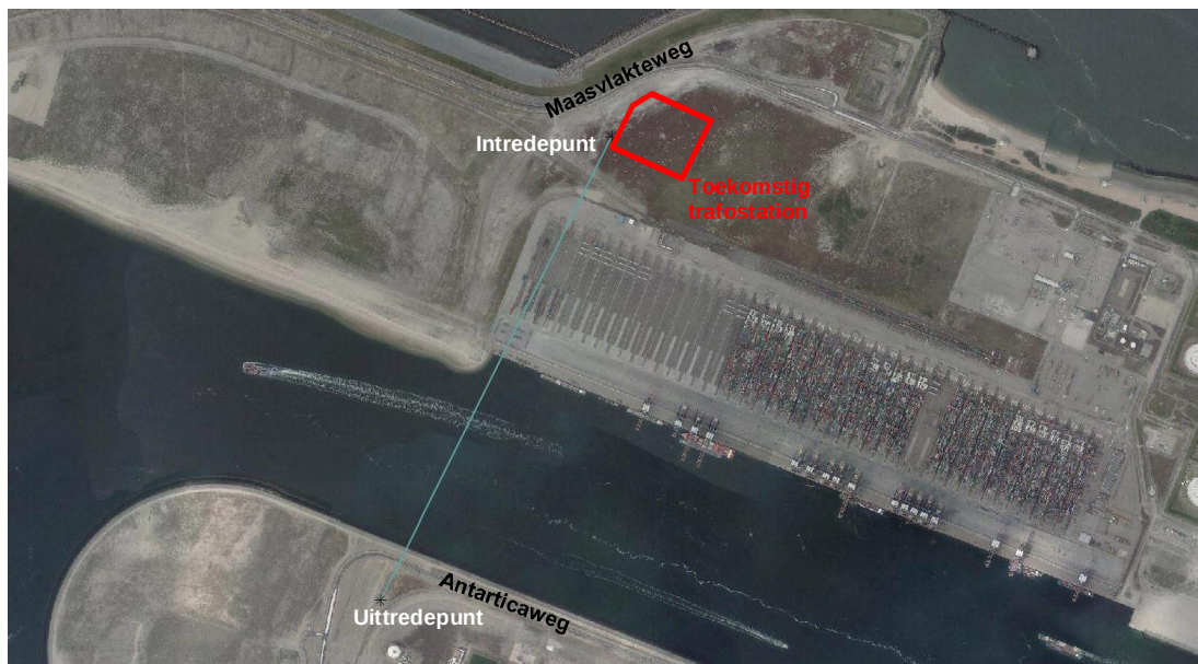
Figuur 1.1 Bovenaanzicht van het boortracé HDD onder de De Yangtzehaven (tekening op basis van de informatie uit [1]).
