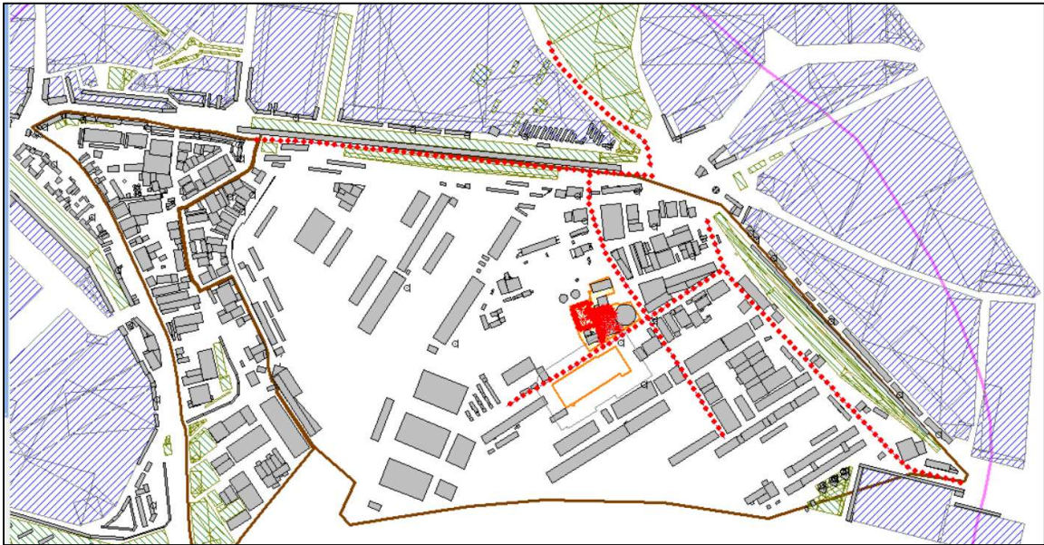
Figuur 5.2 Weergave van het akoestisch rekenmodel
