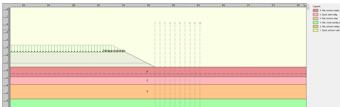
Afbeelding 4.4 Beschouwing zetting ter hoogte van de leiding op meerdere afstanden vanaf de teen van de ophoging
