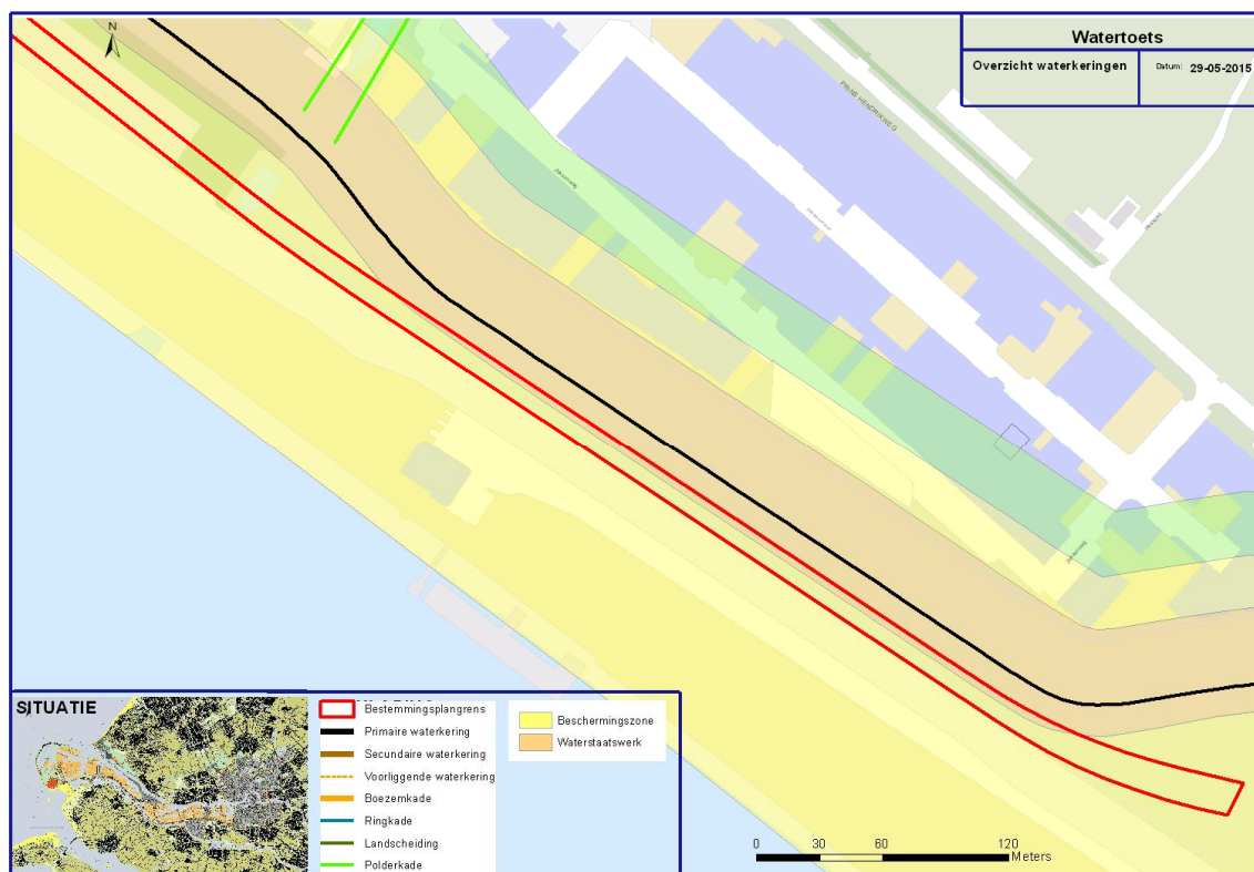
Figuur 4.11 Ligging waterkeringen rondom plangebied (oostzijde plangebied).
