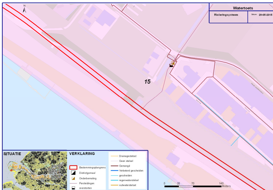
Figuur 4.6 Overzicht rioleringsysteem detail Krimssloot
