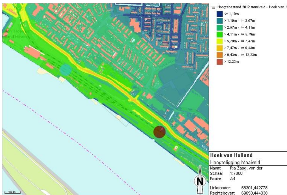
Figuur 5.19 Hoogteligging maaiveld t.p.v. gelijkrichter- en spoorbeveiligingstation Hoek van Holland
