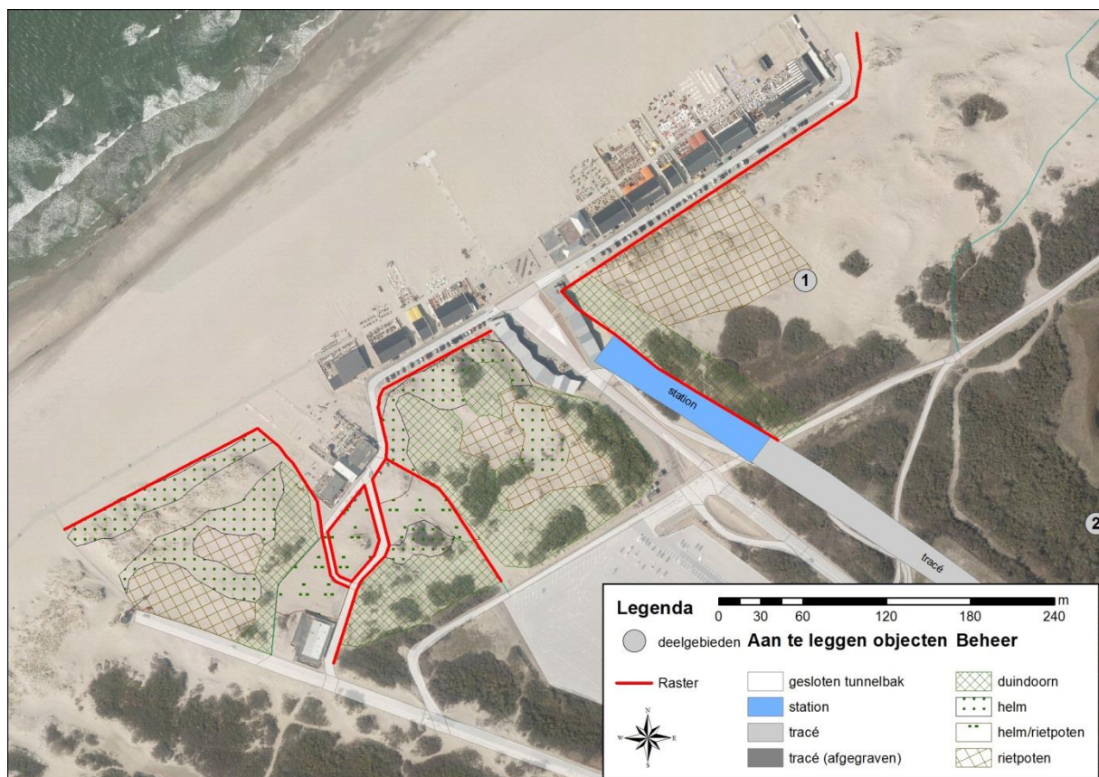
Figuur 2.4. Voorstel voor stuifbeperkende maatregelen rondom het station. Bron: Vertegaal, 2015 en Vertegaal en Arens, 2016.
