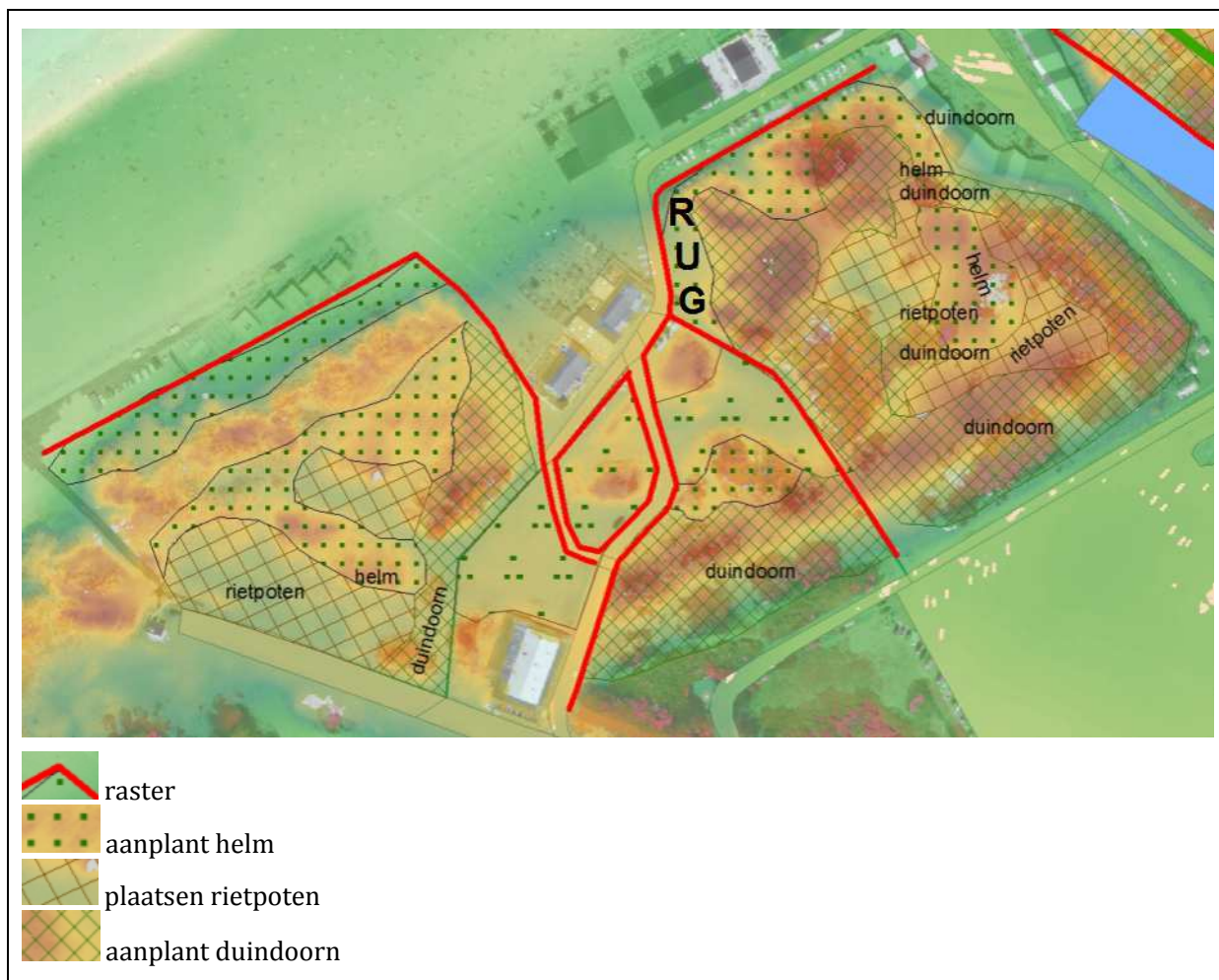
Afbeelding 4.1 Overzicht van de voorgestelde stuifbeperkende maatregelen
