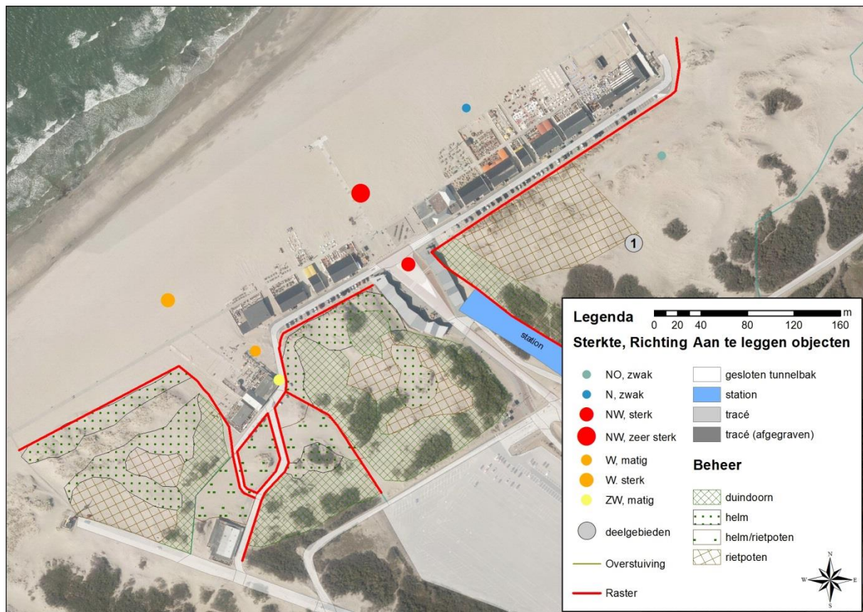
Figuur 4.3. Verwachte mate van zandaanvoer bij verschillende windrichtingen.
