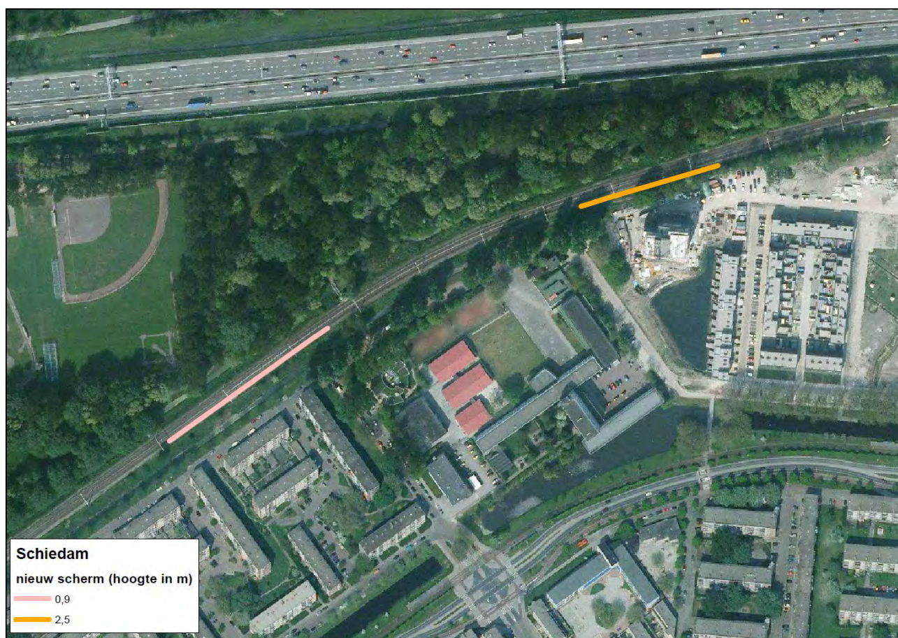
Figuur 0.3 Geluidbeperkende maatregelen Schiedam (maatregelnummer 3 en 4)
