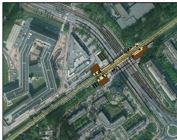
Figuur 6.4 Links: te slopen perron station Schiedam Nieuwland. Rechts: station in alternatief Ombouw. Oranje=perron, geel=publieke toegang tot perron, bruin=buitenruimte.
