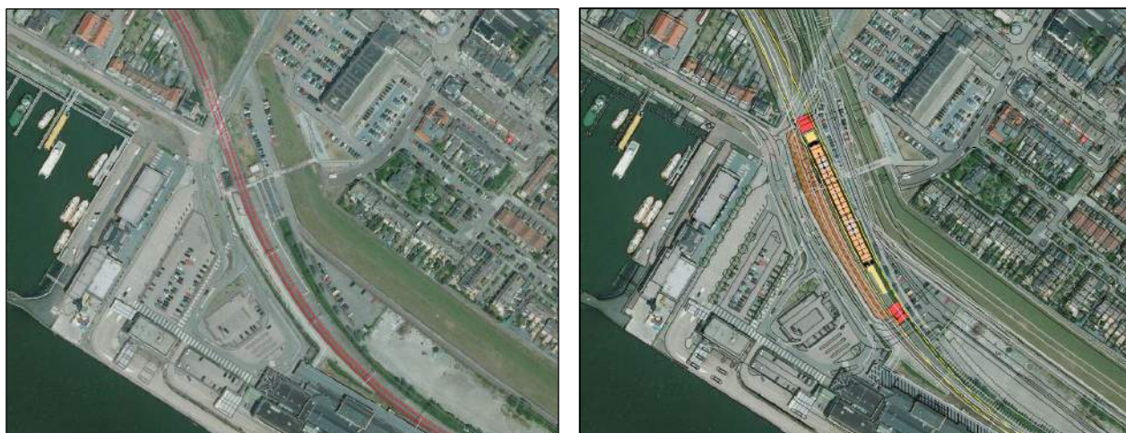
Figuur 6.21 Links: te slopen sporen station Hoek van Holland Haven. Rechts: beeld station in alternatief Ombouw, oranje=perron, rood= overpad/overweg, bruin=buitenruimte, geel=publieke toegang tot perron.
