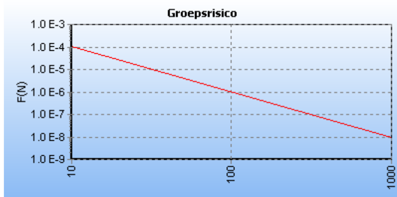
4.44 Figuur 5.44 FN curve voor W-521-38 van N.V. Nederlandse Gasunie voor de kilometer tussen stationing 1420.00 en stationing 2420.00
