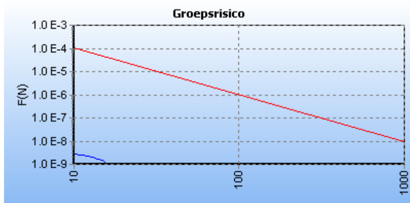
4.29 Figuur 5.29 FN curve voor W-505-01 van N.V. Nederlandse Gasunie voor de kilometer tussen stationing 530.00 en stationing 1530.00
