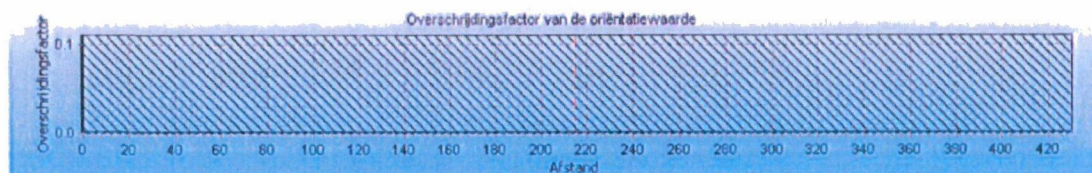
Figuur 12 Overschrijdingsfactor uitgezet tegen stationing van de W-537-05-KR-001 t/m 002 nieuwe situatie. Het gearceerde deel geeft de kilometer aan waarover de FN-curve is berekend.
