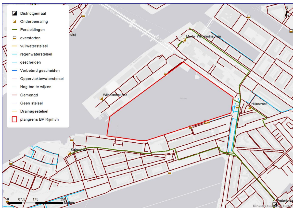
Figuur 4-2 Overzicht rioleringsstelsel
