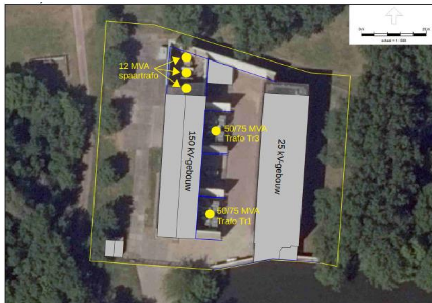
Figuur 2-5: Globale lay-out van transformatorstation Oudeland (Bron: akoestisch onderzoek, Peutz, 2022)
