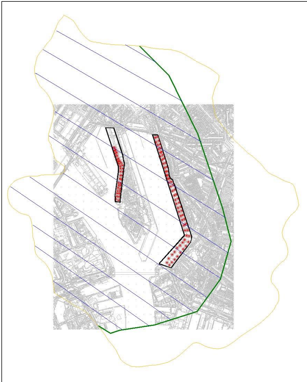
Figuur 1. Ligging van het industrieterrein, de geluidzone (gele lijn), de grenzen van het industrieterrein (zwart) en de 50 dB(A) lijn (groen). Bij de realisatie van geluidgevoelige objecten binnen het gearceerde gebied moet een akoestisch onderzoek worden uitgevoerd.
