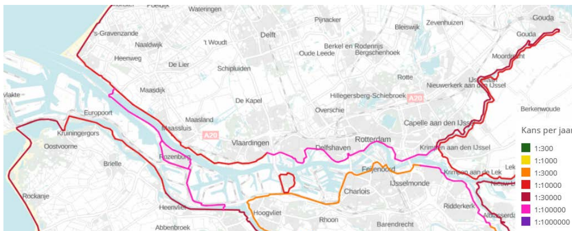
Figuur 3-1 Normspecificaties voor primaire waterkeringen, uitgedrukt in een overstromingskans per dijktraject [2]
