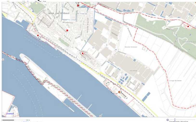
Figuur 5.3 Plaatsgebonden risicocontour voor op- en overslag op het terrein van Stena Line en voor DSM Synres
