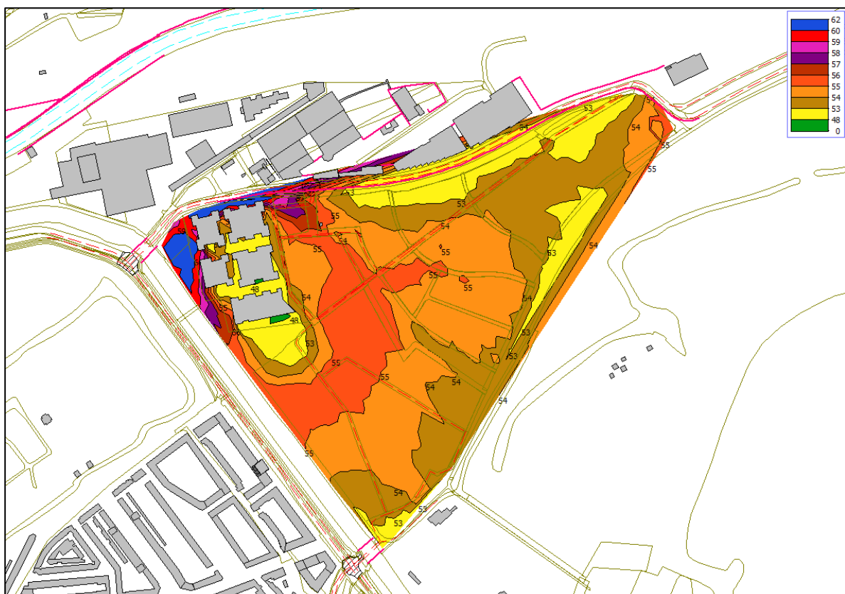
Figuur 4.1: Rekenresultaten rijksweg A20 op 1,5 meter hoogte boven maaiveld
