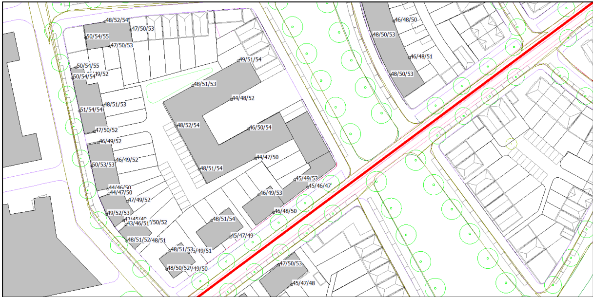
Figuur 4.41: Geluidbelasting vanwege rijksweg A20 inclusief geluidscherm
