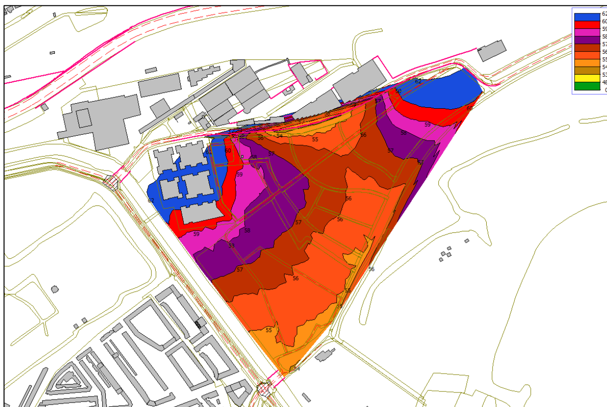
Figuur 4.3: Rekenresultaten rijksweg A20 op 7,5 meter hoogte boven maaiveld
