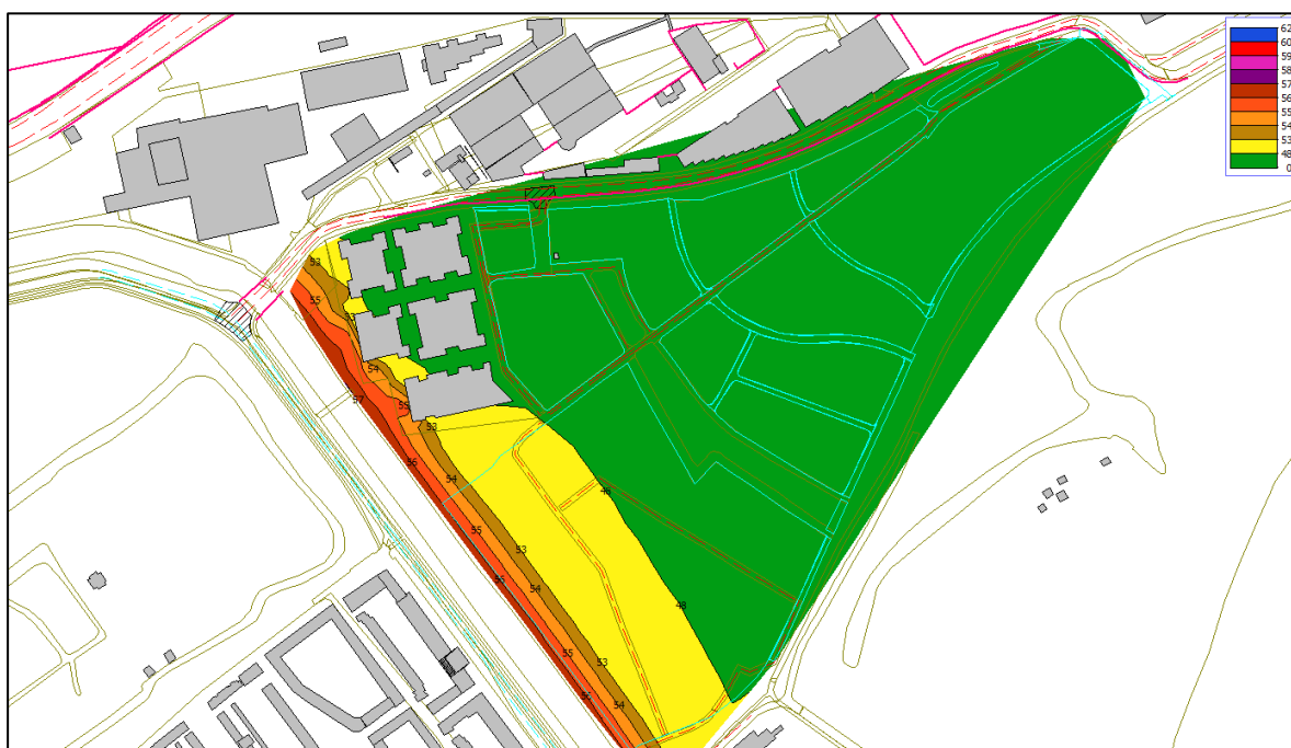
Figuur 4.14: Rekenresultaten Boezemlaan op 4,5 meter hoogte boven maaiveld
