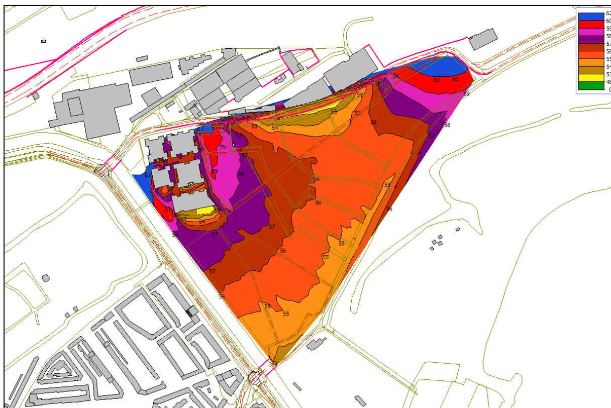
Figuur 4.2: Rekenresultaten rijksweg A20 op 4,5 meter hoogte boven maaiveld
