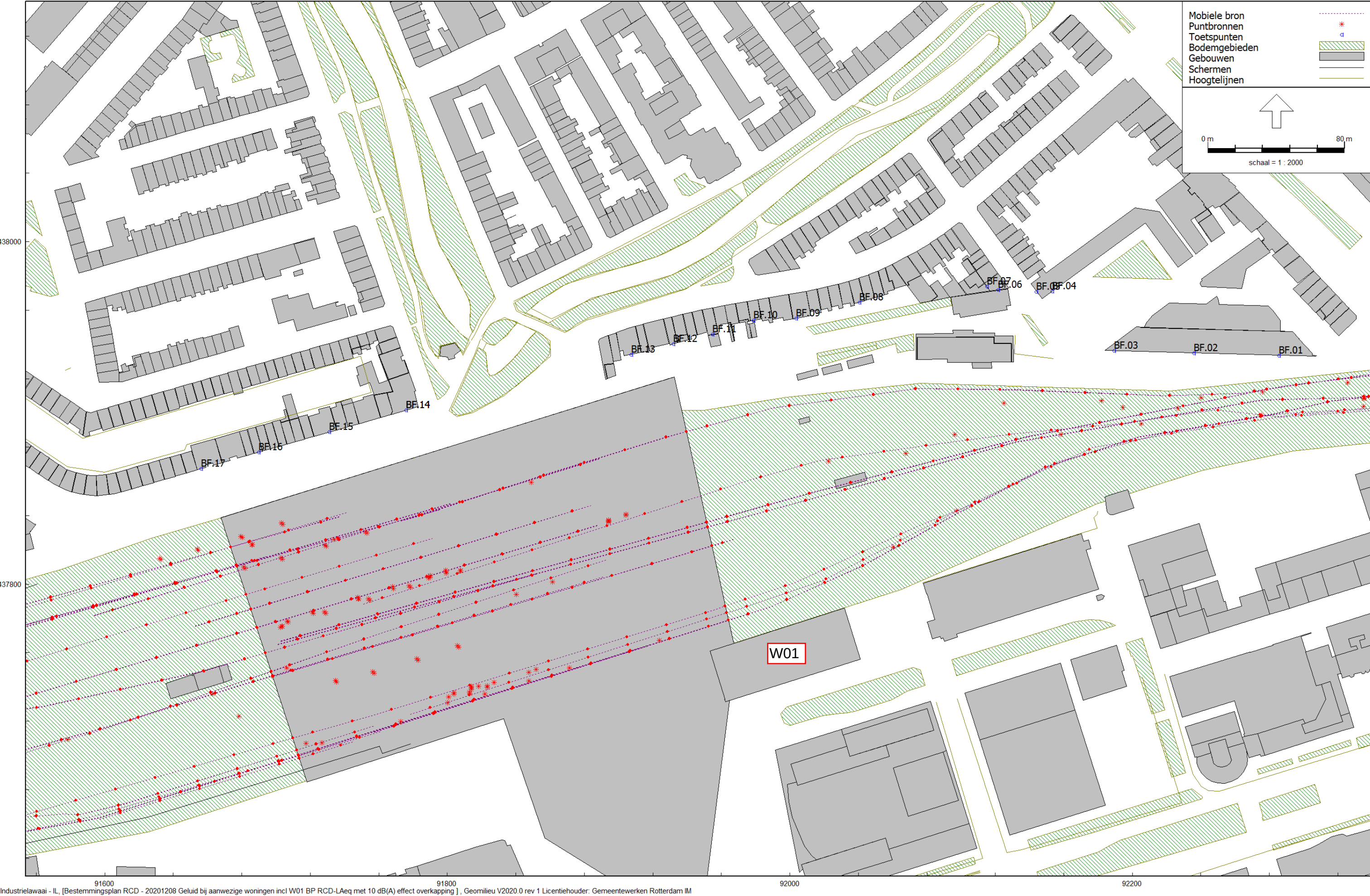
Bijlage 15a: Overzicht rekenmodel emplacement ProRail met rekenpunten bij aanwezige woningen tenv Centraal Station incl. locatie W01
