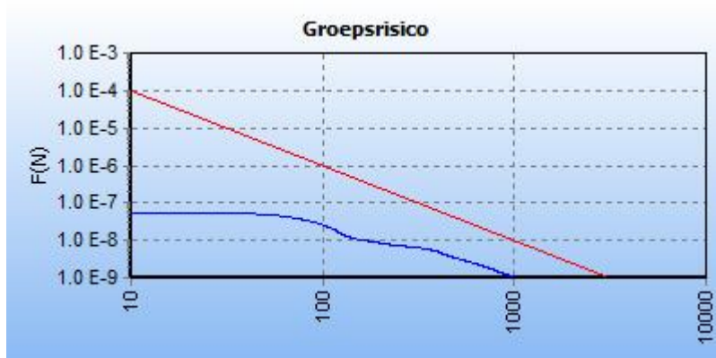
5.1 Figuur 5.1 FN curve voor 6378_leiding-A-518-deel-1 van N.V. Nederlandse Gasunie voor de kilometer tussen stationing 6940.00 en stationing 7940.00
