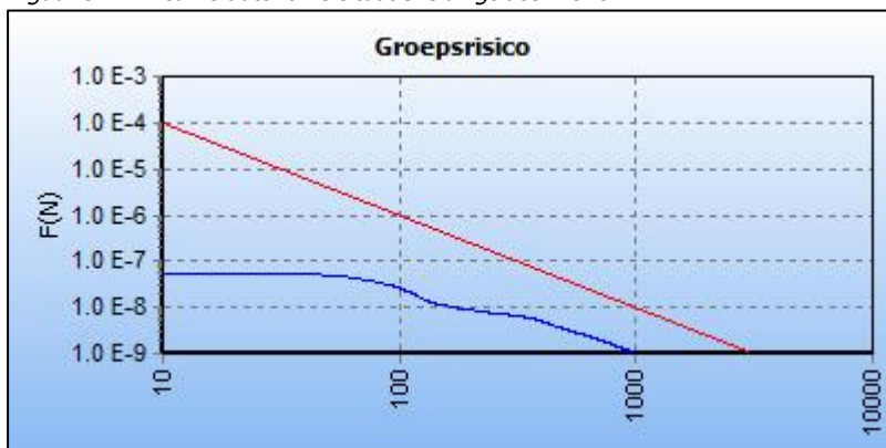
Figuur 5.2: fN curve autonome situatie leidingtracé A-518
