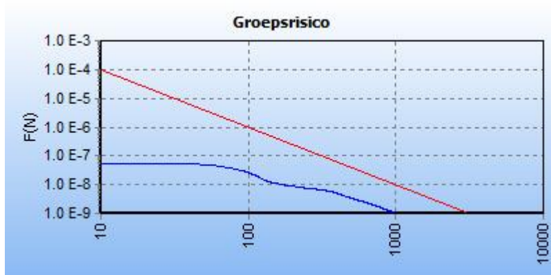
5.1 Figuur 5.1 FN curve voor 6378_leiding-A-518-deel-1 van N.V. Nederlandse Gasunie voor de kilometer tussen stationing 6960.00 en stationing 7960.00
