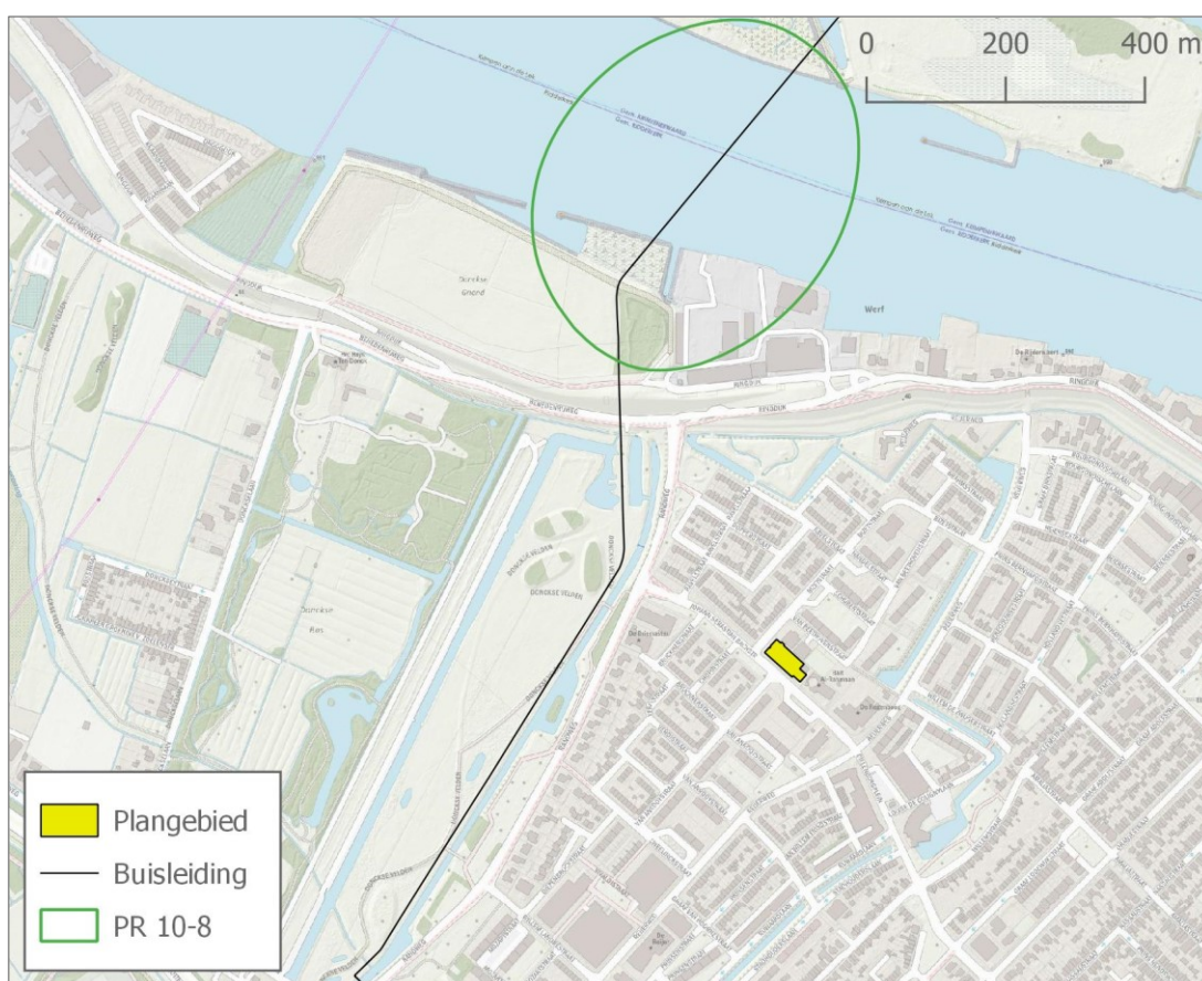
Figuur 3. Plaatsgebonden risicocontouren aardgasbuisleiding A-518
