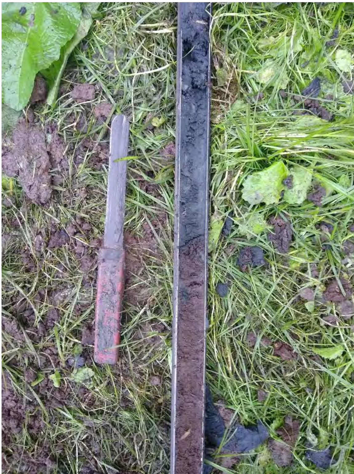
Figuur 6. Het opgeboorde sediment tussen circa 140 en 180 cm –mv in boring 4 met hierin de schuine en erosieve overgang van de slappe en kalkrijke restgeul-/veenstroomafzettingen naar het onderliggende veen.
