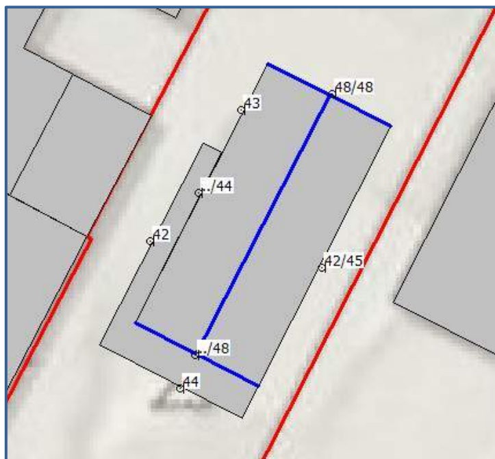
Afbeelding 6. Geluidbelastingen L_{den} (excl. aftrek art. 110g Wgh) cumulatief Berekende geluidbelastingen op een hoogte van 1,5 / 5,0 meter
