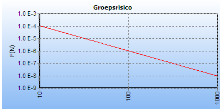
5.1 Figuur 5.1 FN curve voor A-555 van N.V. Nederlandse Gasunie voor de kilometer tussen stationing 76560.00 en stationing 77560.00
