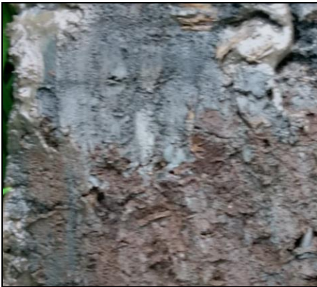
Figuur 7b: detailopname van de overgang van klei naar veen.
