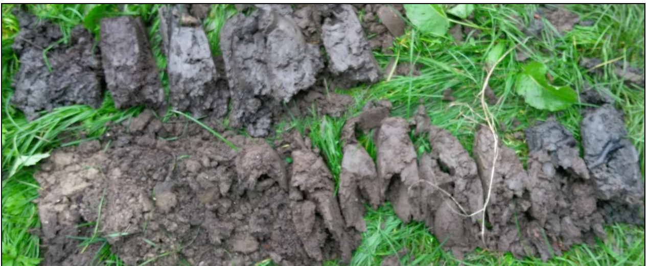
Figuur 7a: Het boorprofiel van boring 3
