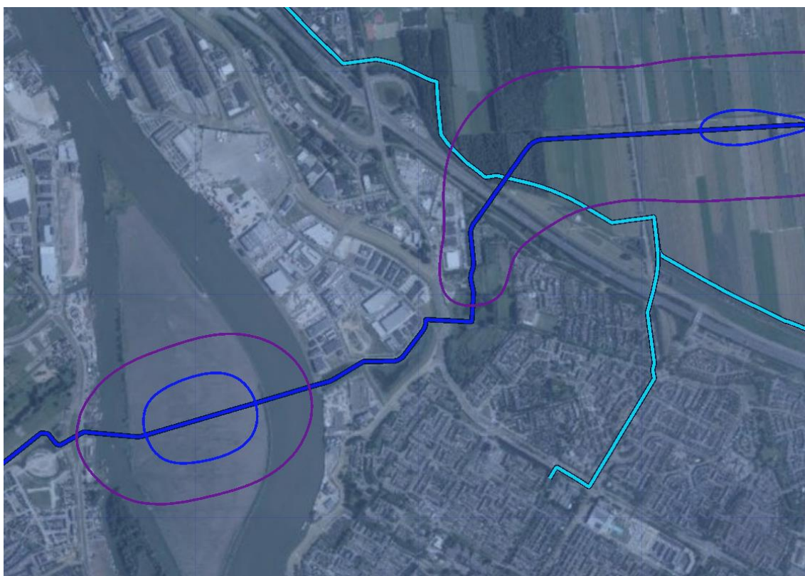
Afbeelding 4.3: Plaatsgebonden risico voor gasleiding A-555
