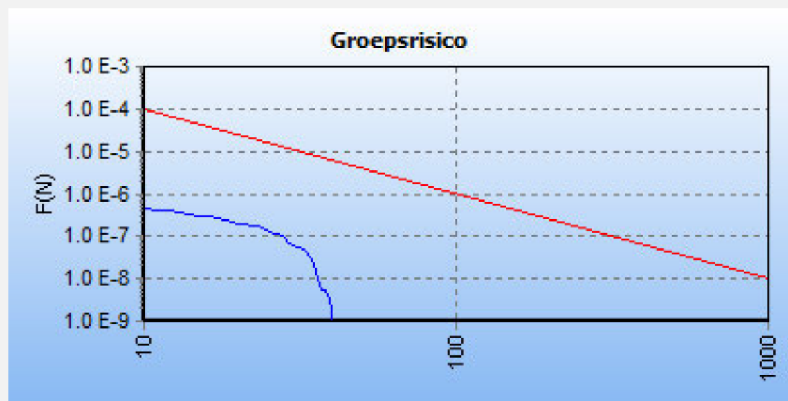
Figuur 6.3 FN curve voor buisleiding W-530-05 van Gasunie voor de kilometer tussen stationing 400.00 en 1400.00 (bestaande en nieuwe situatie)
