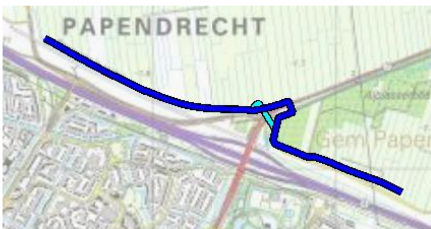
Figuur 1 Ligging van de leiding W-530-01 op een topografische kaart. De ligging van de leiding na verlegging is weergegeven in het lichtblauw; de ligging van de leiding voor verlegging is weergegeven in het donkerblauw.
