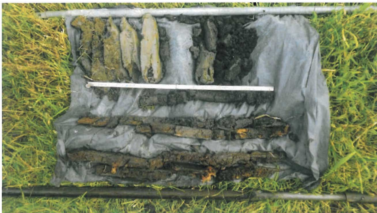
Boring 6: Opname boorkernen en gutskernen.
