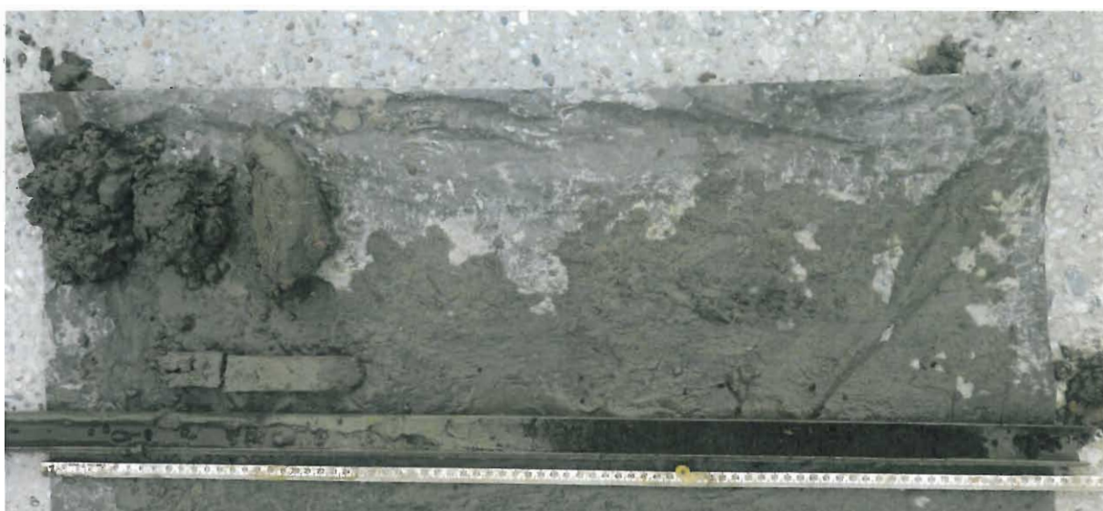
Boring 2: Overzicht boorkernen
