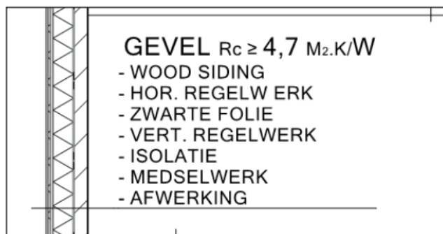
Figuur 2.7. opbouw geveldelen.
