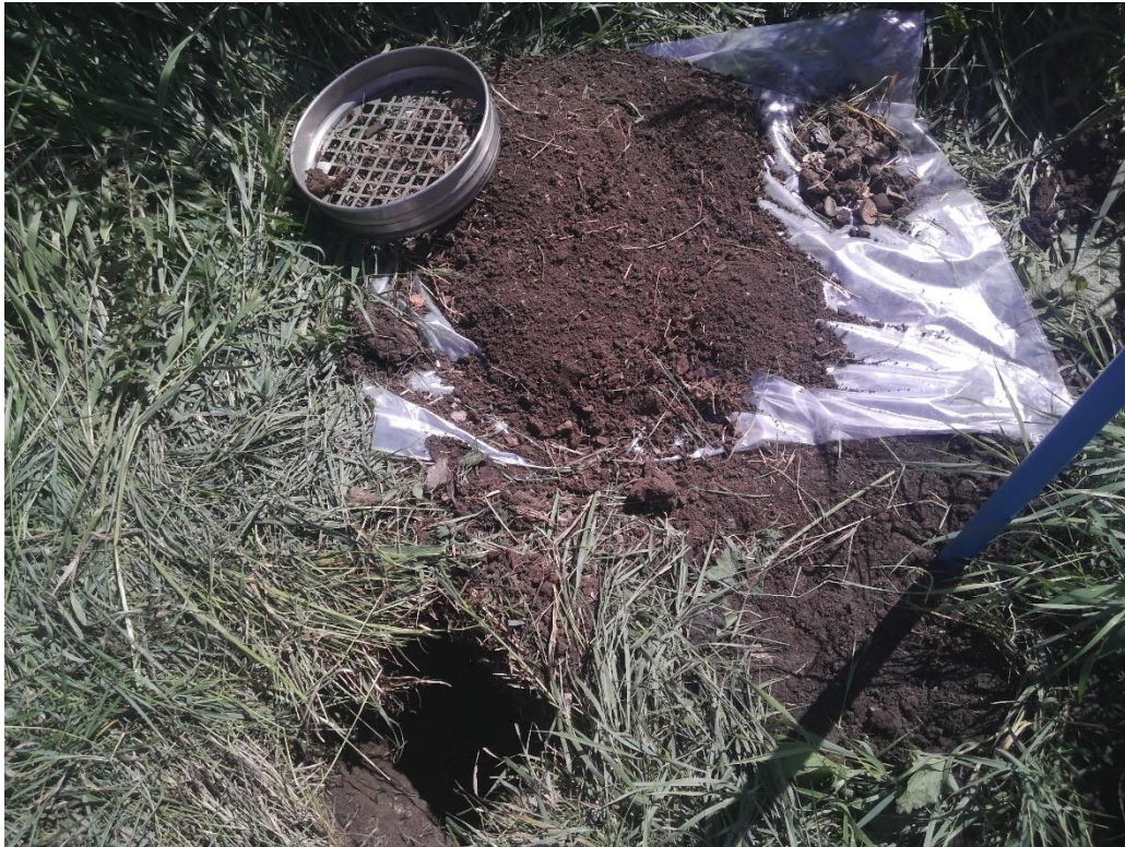
Foto asbestinspectiegat A01
