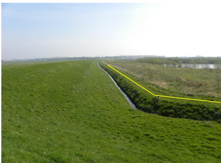
Figuur 13 Locatie bestaande leidingen (geel) binnen dijkbeschermingszone
