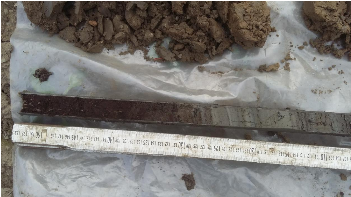
Opname van boring 4: gelaagdheid in de boringen
