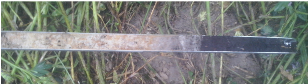
Figuur 8. Heinenoord, P+R terrein Busstation. De geërodeerde top van het veen (donkerbruin) met daar bovenop klei dat is vermengd met brokjes geërodeerd veen.
