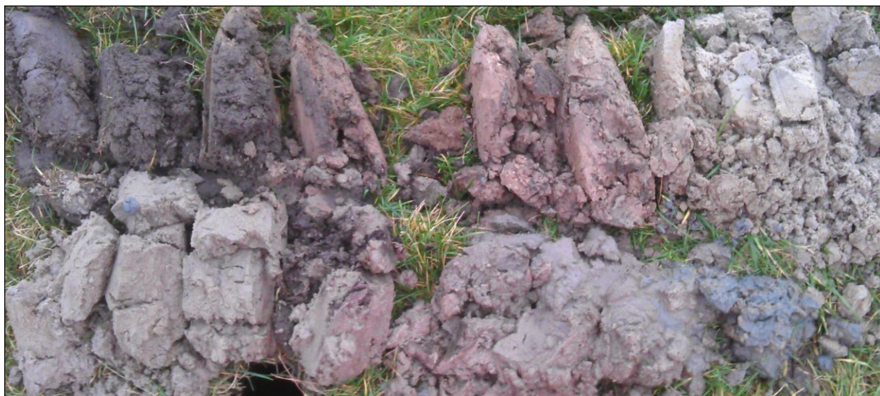
Figuur 6: boorprofiel van boring 1.
